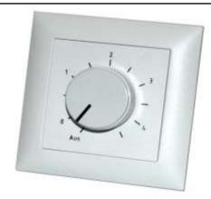
Für Einbau in UP Dosen 70mm ø, Kombinierbar mit Lichtschalter und Steckdose oder für separaten Einbau. Dient zum Ein- und Ausschalten einer Heizung im eingestellten Takt. Jeder Wert zwischen ganz EIN und ganz AUS kann eingestellt werden Z.B. 40% ein und 60 % Aus. Dadurch ist eine Regelung ohne Fühler möglich. Es lassen Sich je nach Auslegung der Heizung verschiedenen Maximaltemperaturen erreichen.
